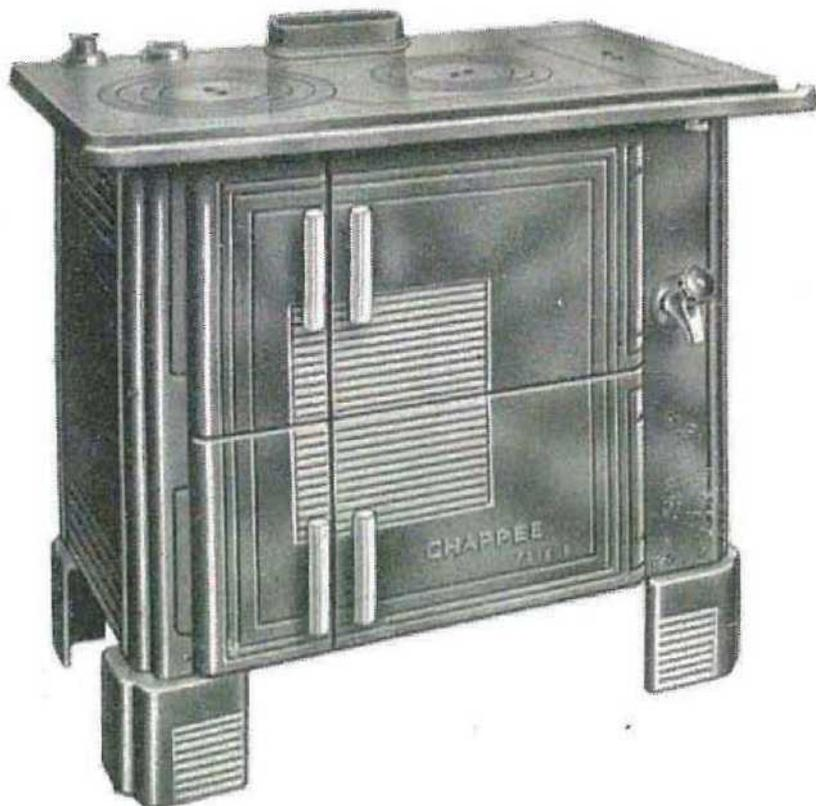
Cuisinière avec façade et côtés en fonte émaillée (gris-bleu, chamois ou blanc), intérieur en tôle avec dessus de four en fonte. Dessus meulé, foyer mixte bois et charbon, portes ouvrantes, bain-marie, robinet et barre devant, buse ovale au milieu, dessus ou derrière. Bouilleur en tôle d'acier éprouvé à 4 kg./cm<sup>2</sup>.
